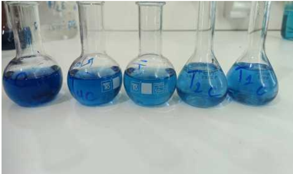
Figure 05 : virage de couleur obtenus dans la préparation de la courbe d'étalonnage de ortho phosphates
