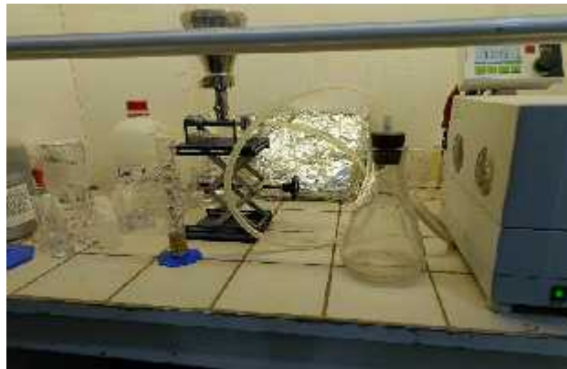
Figure 07 : Photo rampe de filtration sous vide
